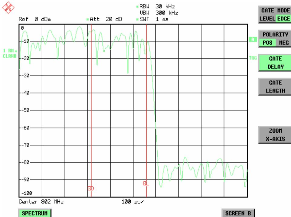
Bild 4-12 Einstellung der Zeiten GATE DELAY und GATE LENGTH im Zeitbereich mit Hilfe der Linien GD und GL
